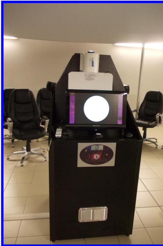
Se trata de un planetario digital con imagen a resolución mayor, con un número superior al 30% de pixel respecto al modelo Full HD (igual a 1200 pixel al meridiano).
